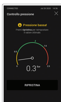
Ripristino semiautomatico pressione impianto
